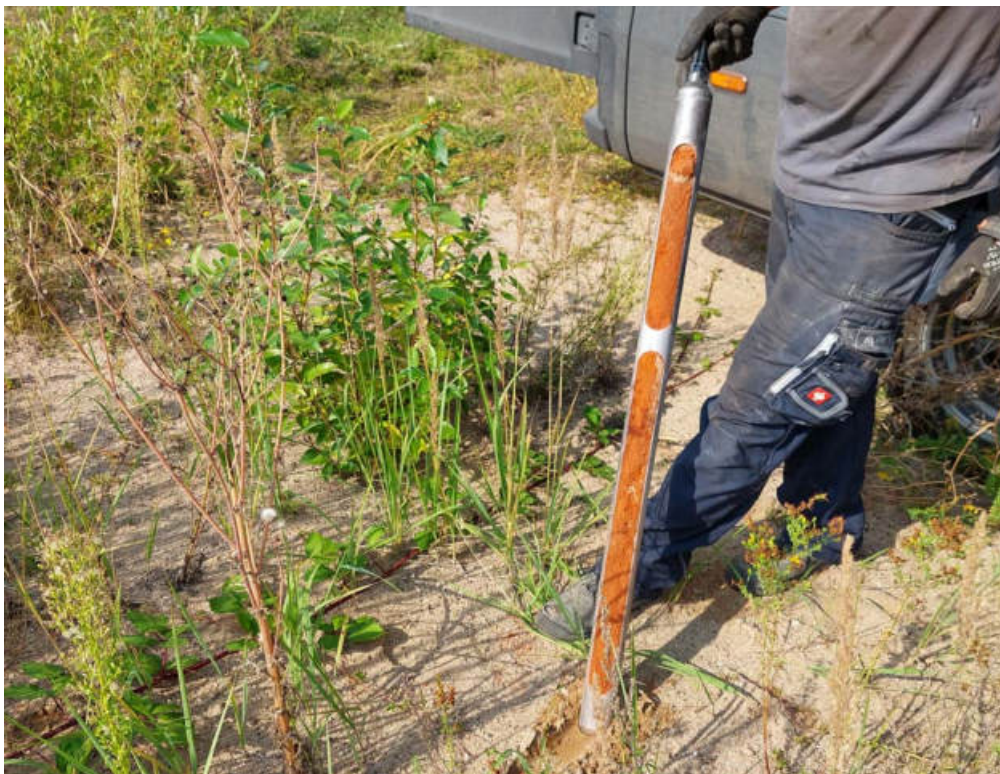
Abbildung 1: Erster Bohrmeter bestehend aus Ziegelresten an der BS 13
